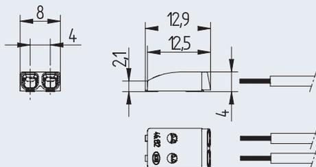
Generelle Empfehlung: Die beiden Lötflächen eines Klemmpoles auf der Platine sollten elektrisch miteinander verbunden werden
